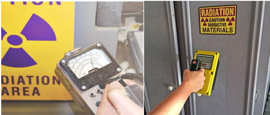
រូបភាព១៩ ឧបករណ៍វាស់ស្ទង់វិទ្យុសកម្ម(Radiation survey meter)
