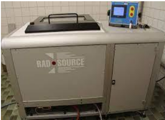
រូបភាព៣ ឧបករណ៍បញ្ចេញកាំរស្មី x ប្រភេទ RS-2400 ផលិតដោយ RAD Source Technologies, Inc, USA)
