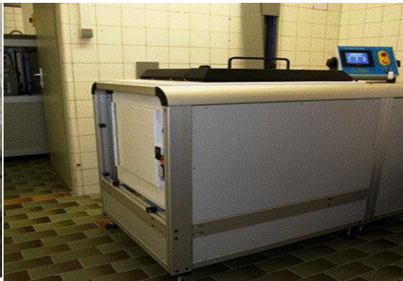
រូបភាព៣ ឧបករណ៍បញ្ចេញកាំរស្មី x ប្រភេទ RS-2400 ផលិតដោយ RAD Source Technologies, Inc, USA)
