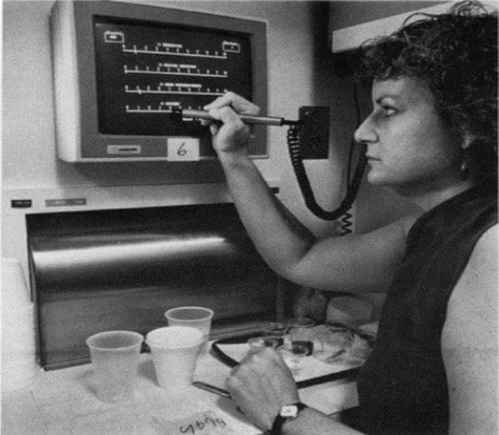
រូបភាពទី៥.២ ឧបករណ៍ស្នង់សម្រាប់ការវាយតម្លៃតេស្តដោយញាណនៃសំណាកនីមួយៗដែលមានភ្លើងសម្រាប់បំភ្លឺគ្រប់គ្រងហើយឆ្លងកាត់ការបង្ហាញជាកំរុំ
